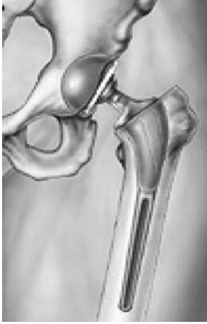
Şekil 1. Metal, seramik ve yüksek molekül ağırlıklı polietilen biyomateryallerin bir arada kullanımı ile oluşturulmuş total kalça protezi şematik görünümü
